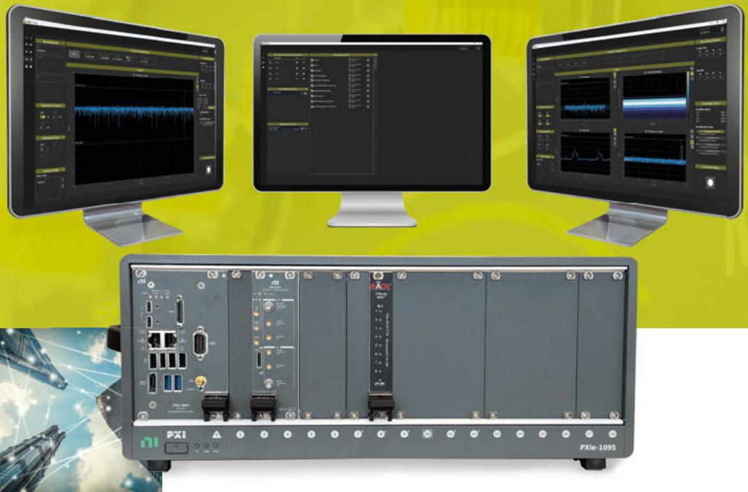
**RP-6500 von Averna** ist eine All-in-One-Breitbandlösung für **RF-Aufnahme und Wiedergabe** mit einem **Real-Time-GNSS-Simulator** und einem **SATCOM-Signalgenerator**, der modernste Anwendungen zur Satellitennavigation unterstützt.
